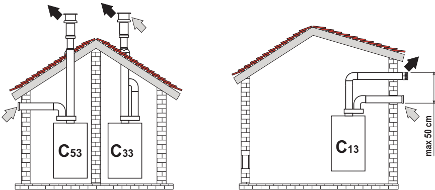
fig. 35 - Esempi di collegamento con tubi separati
