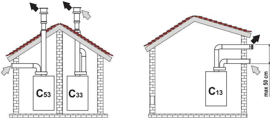
fig. 35- Exemple de racordare cu tuburi separate
